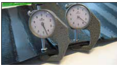
Lo spessore del sormonto è inferiore a quello delle strisce garantendo la massima stabilità ai pannelli isolanti posati a cavallo del sormonto
